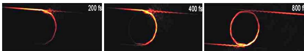
Figuur 1. Drie opnames in de tijd van licht dat van een rechte lichtgeleider (boven in beeld) koppelt naar een opslag ring. Tussen de opnames zit 0,2 biljoenste seconde.
